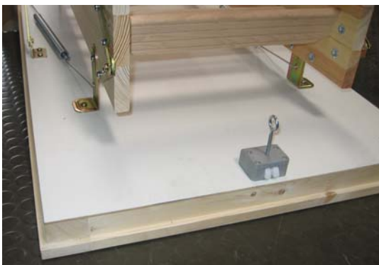
Bild 3 Deckelaufbau und -verriegelung
